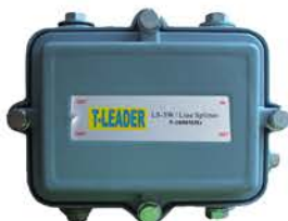
Line Splitter Frequency 5-1000 MHz แยกสัญญาณ สายเมน มีอัตราการสูญเสียต่ำ(ค่า loss)เพียง 3.5/7dB ทำจากวัสดุอย่างดีที่สามารถกันน้ำได้ดี -รหัสLS-2 2way -รหัสLS-3 3way
