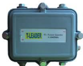
Power Inserter Frequency 5-1000 MHz 2way จ่ายไฟกรงกระแสไฟไม่ให้เข้าไปกวนสัญญาณ จาก powersupply ไปเลี้ยงTrunk Amp. รองรับแรงดัน 120 โวลท์ กระแส 20 แอมป์ ทำจากวัสดุอย่างดีที่สามารถกันน้ำได้ดี -รหัส PI
